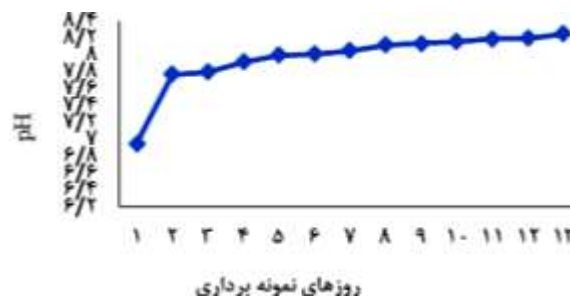
شکل ۸: تغییرات pH در سیستم بیودراف در طی دوازده روز نمونه‌برداری
