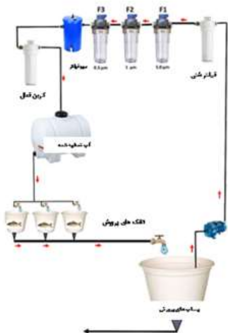
شکل ۱: نمایی شماتیک از سیستم مدار بسته طراحی شده جهت پرورش کپور معمولی
