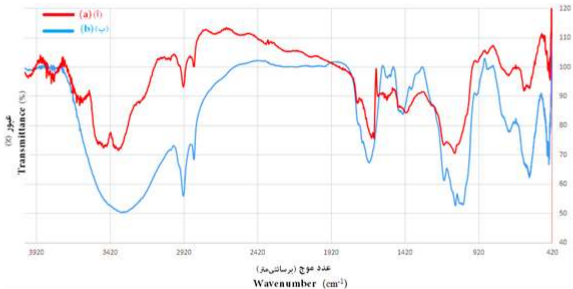
شکل ۲: آنالیز طیف سنجی مادون قرمز نمونه محصول اسیدوژنیک تاپ‌کلر در قبل (آ) و بعد از فرآوری (ب)
