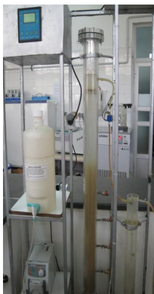
شکل ۱: بیورآکتور آزمایشگاهی تلفیقی هوازی / بی هوازی با لجن گرانوله مورد استفاده در سیستم پیوسته تصفیه
